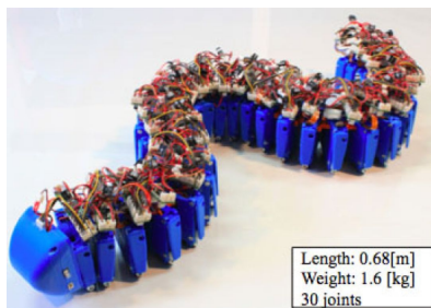
図5：開発したヘビ型ロボット
