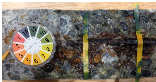
図-3 電食試験後の鋼材の pH
