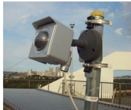
図2 屋外ネットワーク可視カメラ（Panasonic製のBB-HCM735）の設置例。稲毛ヨットハーバーから都心部方面を望む。
