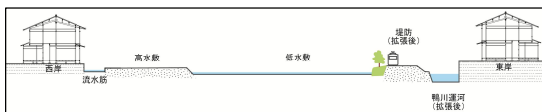
図1 三大事業時に実現した運河堤防上への樹木植付による風致保全策
