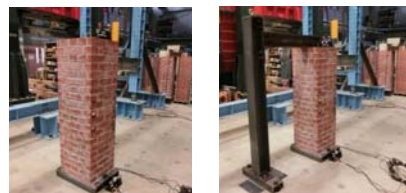
(a) 鉄骨付加前 (b) 鉄骨付加後 写真 7 常時微動計測の様子
