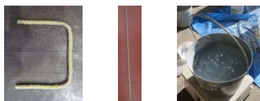
(a) 縦目地用 (b) 横目地用 (c) CNF 写真1 新素材
