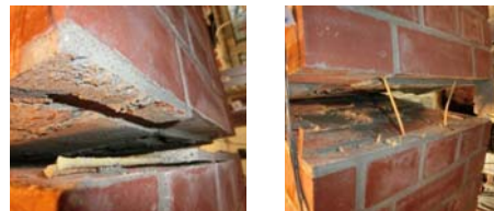
(a) W-AR1 : ロッド (b) W-AR2 : ロッド引抜 写真 6 代表的な損傷
