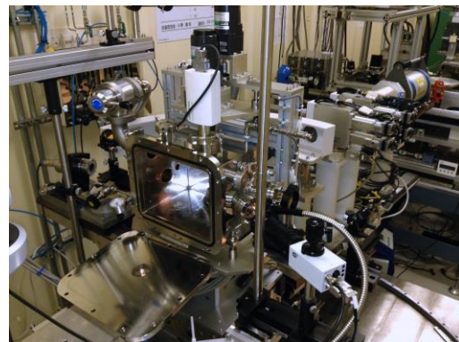
図 2 SPring-8 の BL04B2 ビームラインの試料ステージへ設置したレーザー加熱型ゾーンメルト装置。
