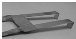
搔破ツール 図1：痒いところを掻いているときの様子。皮膚に電極を貼り付け、微弱な電気を流すことで痒みが誘発される。その皮膚を爪に見立てた銅版 (搔破ツール) で搔破する。この方法により、掻いたときに生じる快感を実験的に再現することができる。
