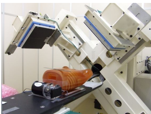
図3 CBCT撮影試験装置および動体ファントムを用いた四次元CBCT撮影検証試験
