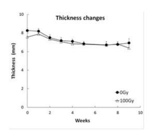
粒子線照射による結果として炭素イオン線 100Gy 照射したスペーサーと、非照射( 0Gy ) のスペーサーでは、ラットに埋植状態においてその消褪速度(厚みの変化)に両群に差を認めなかった。100Gy は通常がん治療に用いる線量の約2倍の高線量であるため、本実験結果からも被験物質は粒子線照射による性状の変化は殆どないことが予想され、少なくともスペーサーの厚みの変化には影響を及ぼさないことが確認された。
