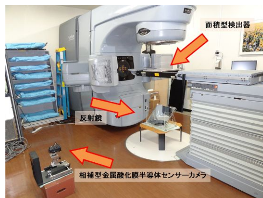
図 3 MLC の機器精度の評価における実験系、面積型検出器から放出された光を 90° 反射させ相補型金属酸化膜半導体センサーを有するカメラにより蛍光画像を取得
