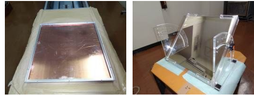
図 2 製作した面積型検出器と反射鏡
