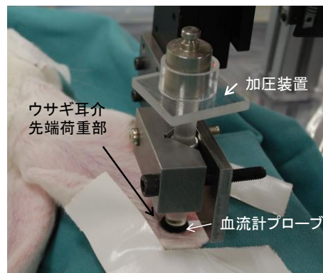
図1 ウサギ耳介のクリープ変形に伴う血流量変化の測定
