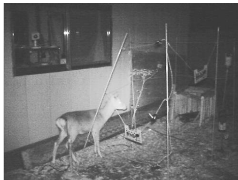
図5. 動物用ワイヤレス給電システムのプロトタイプに接近・検出されるニホンジカの様子
