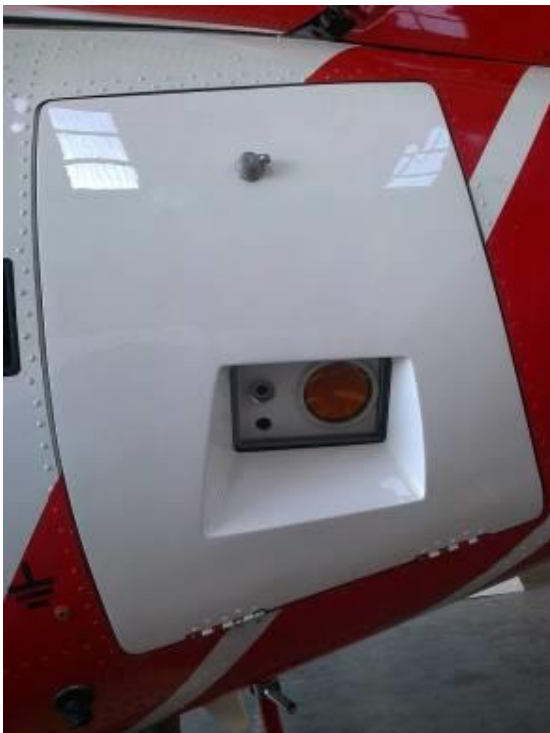
図：携行型マイクロ波放射計のヘリへの設置の様子。
