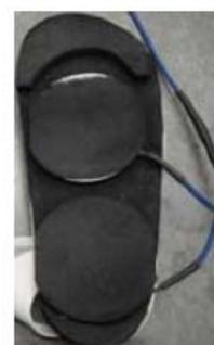
(b) 移動式床反力計の裏面
