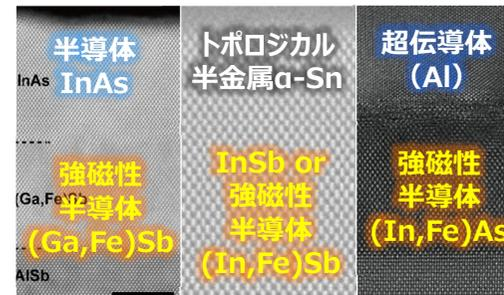
図3. われわれが作製する半導体上の様々な高品質ヘテロ構造
