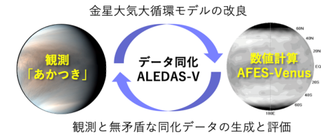
図2 「データ同化」を介して「モデルの改良」と「同化データの生成」を再帰的に推進
