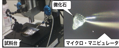
図5 AI（人工知能）を用いた微化石/微粒子の自動判別/ピッキング装置
