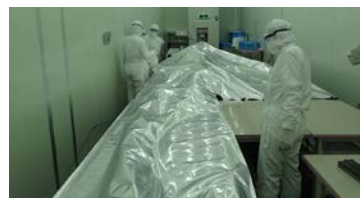
図2. 保護袋に入れ窒素ガス密封する直前の00ミニバルーン。
