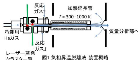
気相生成したクラスターを室温から1000 Kまで加熱できる加熱延長管に通す(図1)。約100 μsの通過時間の中に、周囲のキャリアガスのヘリウムガスとの多数回に亘る衝突によって熱平衡状態となり、熱エネルギーによる反応が誘起される。この手法によって表面科学で一般的に行われる昇温脱離法(TPD = temperature programmed desorption あるいはTDS = thermal desorption spectrometry法)と類似した情報を得ることができるようになった。後者では基板の表面を昇温しながら脱離してくる化学種をモニタするが、気相昇温脱離法では質量スペクトルで各々のクラスターの強度変化をモニタしながら昇温し、脱離を調べる。
