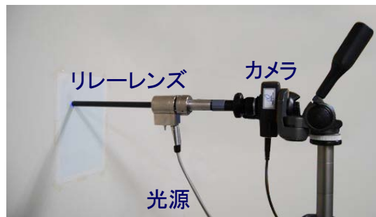
図1 試作した内視鏡型プローブ
