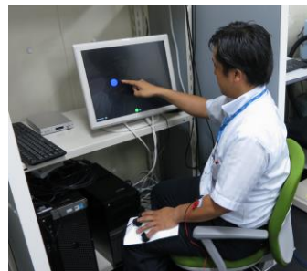
ボタン押し動作の実験装置。被験者は、連続的なボタン早押し動作を覚える。左手の GSR, PPG を測定する。緊張を誘発するため、被験者には間違えると左手に軽い電気ショックを与える。
