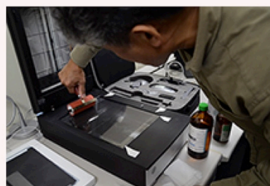
液体でガラストップに密着させてスキャンングする方法
