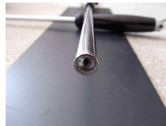
図8 球面超音波モータを用いた試作内視鏡
