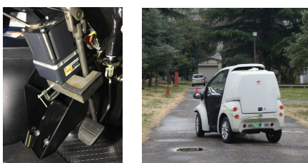
図6 モータを取り付けた小型電気自動車と実験の様子
