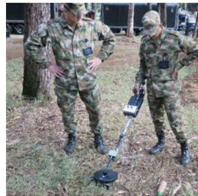
図 15: 開発した地雷探知装置を用いて、コロンビアに多く埋設されているタイプの実物の非金属材料地雷を測定してもらっている様子。
