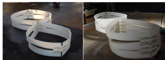
(a) 制振パネル2段式 (b) 制振パネル3段式 写真-18の字型浮体式制振装置
