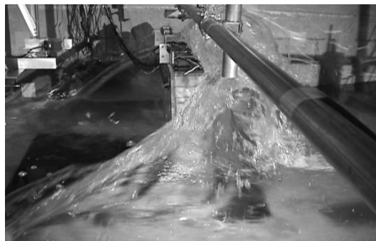
(a) 傾斜した標準試験体
