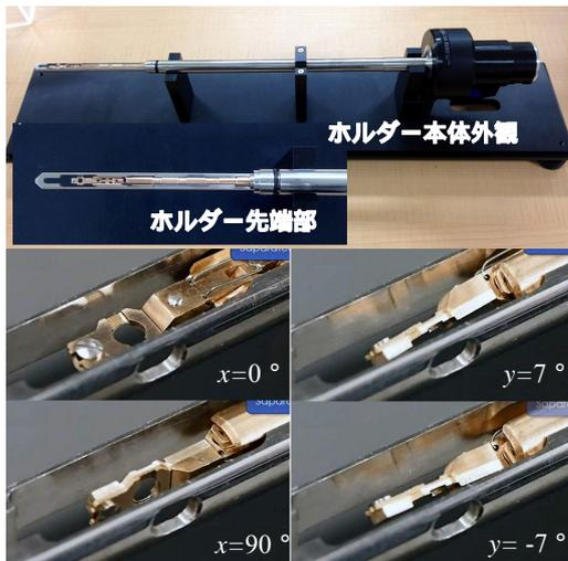
図 2: 本研究で設計・製作した、3 軸試料方位調整機能を有する電子顕微鏡ホルダー。ホルダー ( $x$  軸を中心に  $360^\circ$  全方位回転が可能。試料台手前にレーザー照射窓が開いている。
