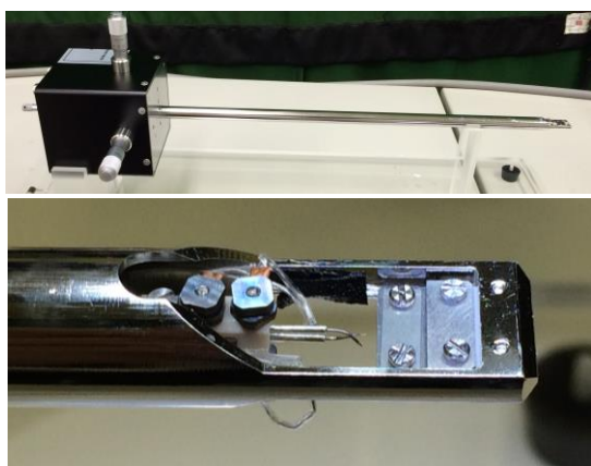
図3. 開発された粗動機構付ピエゾホルダー芯軸の外観と試料支持部付近
