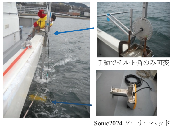
図1 専用治具により実習艇「いつもり」の船舷に取り付けられたSonic2024
