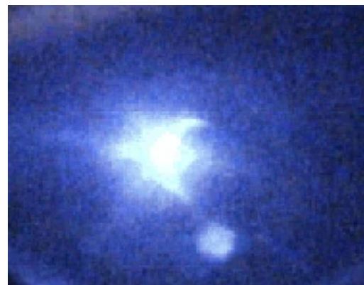
図1 グラファイト同軸電極を用いたアーク放電形成と炭素不純物放出
