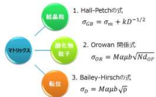
図 3 : ODS 鋼の強化因子
