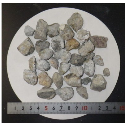
写真-1 再生骨材 M の外観
