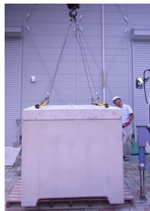
写真-4 鉛ガラスを用いた保管容器の一例
