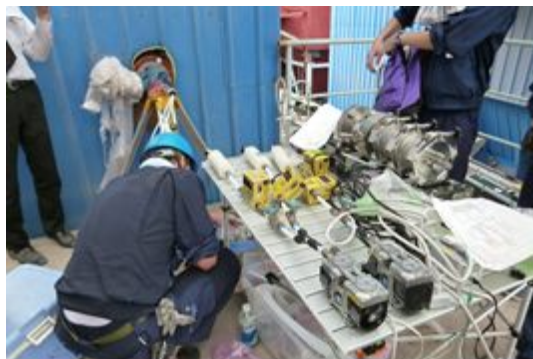
写真4 Virtual impactor によるサンプリング
