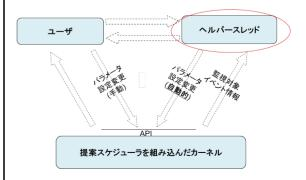
スレッドスケジューラのフレームワークに ヘルパースレッドを組み込み、さらにインタ フェースを準備した。エネルギー消費と公平 性を両立するなどといった観点から好ましくないイベントが削減できるように、振るったいを変えるパラメータを設定できるういパースレッドは、パフォースカウンターをモニターし、スレッドよるマンスカウンターをモニターし、スレッドよるできるできる。以下の図のように、静間ではいる。以下の図のように、静間では、段階を分け複数の指標で基づいて推定を行いながら動的に設定値を変更するなど、複数の指標で基づいて設定値を変更するなど、複数の指標でエネルギー消費量の最適化を目指した。
