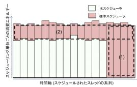
スレッドアプリケーションの実行効率を向上させる。この実行効率の向上は、実行時間だけでなく、消費エネルギーの削減にも有望と考える。上図にその概念を示す。図の(1)はオーバーヘッド削減に伴う実行時間短縮によるエネルギー削減を示し、(2)は実行オーバーヘッド削減による単位時間当たりのエネルギー削減の集積を示している。
