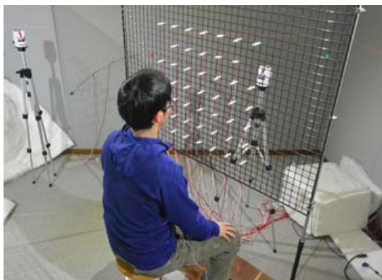
図 3. 受聴者正面の平面上の HRTF 測定風景
