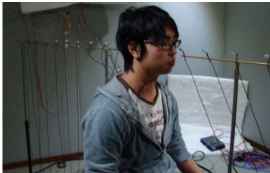
図 2. 頭部中心から放射状に延びる直線上の HRTF の測定風景
