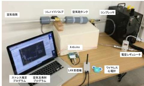
図2 涡輪触覚ディスプレイシステム
