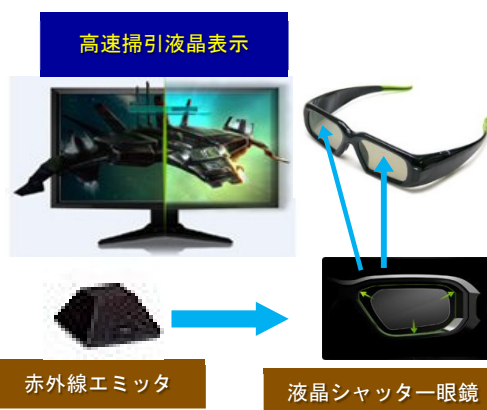
図3-5 3D 立体視の仕組み
