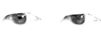
フィルタ有り フィルタ無し 図7 偏光フィルタによる目画像の変化
