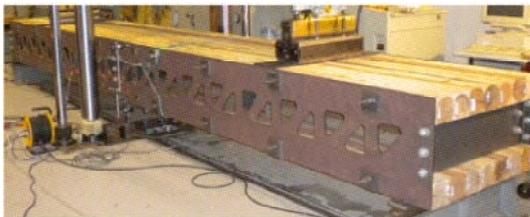
写真1 オンサイト木橋試験体
