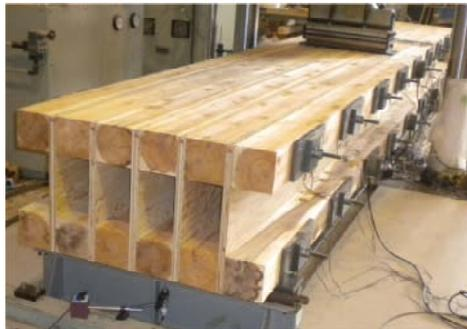
写真3 合板を用いた応急橋
