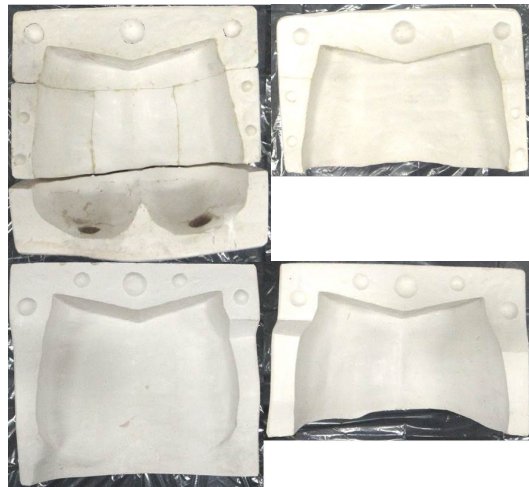
図 3.8 石膏型の様子 (上：筋肉層型，下：脂肪層型)
