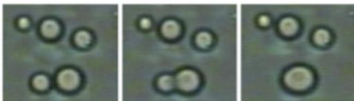
図3 電場印加条件下でのミクロスフィアの融合挙動
