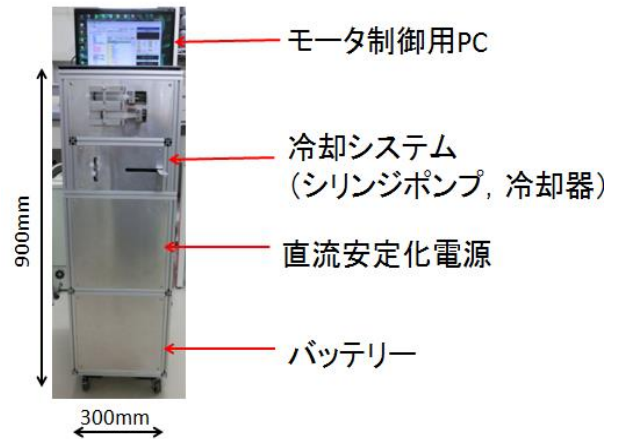
図6 病棟用脊髄局所冷却システム
