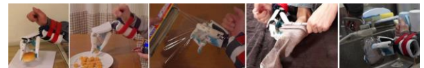
図10 ヒト近似外装構造ハンドによる、日常生活下における両手を使ったADL動作
