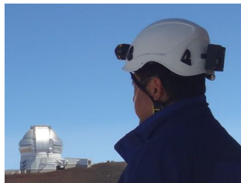
図2 マウナケア山頂における記録実験(ヘルメット後部に、本研究で開発した小型高機能行動記録装置が装着されている)
