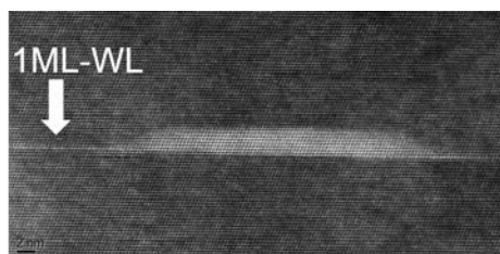
図 8 InAs 量子ドットの断面 TEM 像
