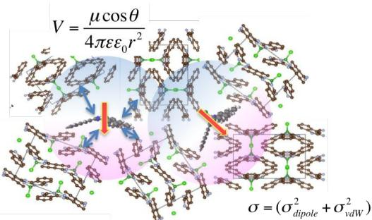
図 10 SubPc 薄膜の構造乱れに伴う、ポテンシャル揺らぎ発生のモデル図
