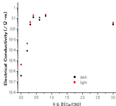
図 2 Ca ドープ C<sub>60</sub> 薄膜の電気伝導度
