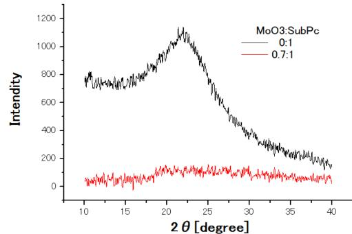
図 6 MoO<sub>3</sub> ドープ SubPc 薄膜の X 線回折
