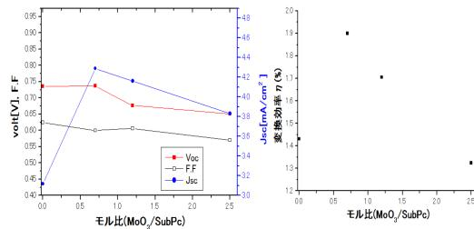
図 7 MoO<sub>3</sub> ドープ SubPc 薄膜の採用による SubPc/C<sub>60</sub> 太陽電池の(左)デバイスパラメータと(右)変換効率
