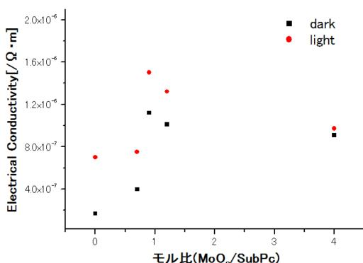
図 5 MoO<sub>3</sub> ドープ SubPc 薄膜の電気伝導度
