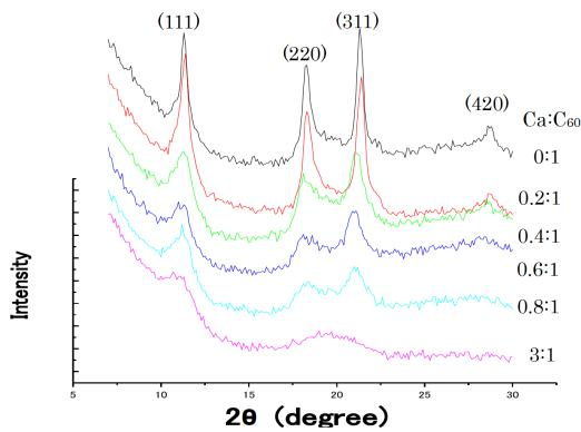
図 3 Ca ドープ  $C_60$  薄膜の X 線回折
