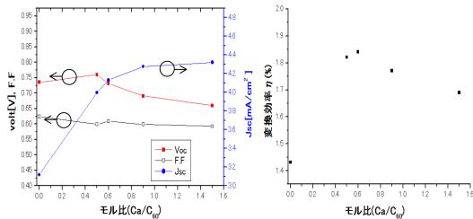
図 4 Ca ドープ  $C_60$  薄膜の採用による SubPc/C<sub>60</sub> 太陽電池の(左)デバイスパラメータと(右)変換効率
