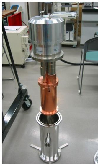
写真 2: パルスチューブ冷凍機に輻射シールドを取り付け、クレーンを使って真空チャンバーに降ろしていくところ。
