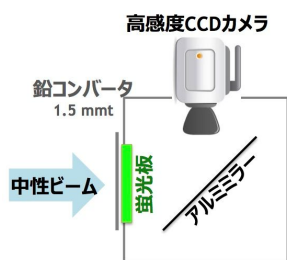
図 3 ビームプロファイルモニター概念図 [2]
