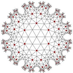
この格子は再帰的な構造を持っており、負の曲率半径が、7分岐点間の距離に比例することを、容易に示すことができる。この格子上のイジング模型を、相転移解析の対象とすることにした。なぜならば、双極格子上の共無統計モデルに対応する1次元量子系を、量子・古典対応を通じて推察すると(解析的な詰めが甘い所はあるが)双極的に変形された1次元量子系が対応していると考えられるからである。
