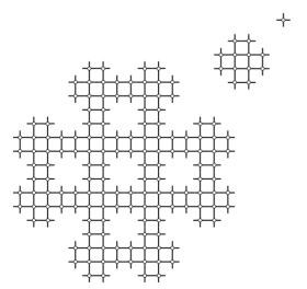
フラクタル格子には様々な種類があるが、図に示した構造の場合には、TERG 法と呼ばれる実空間繰り込み群手法が有効に使える。 我々は、イジング模型について、高次特異値分解を用いた TERG 法(論文[5]参照)によっ て、この系の比熱を求めた。(論文[2]参照) その結果は、比熱が特に何の特異性も示さな いように見えるものであった。しかし、詳細 にデータ解析を行ってみると、弱い特異性が 比熱に内在されており、相転移点で比熱の温 度微分が発散していることが判明した。
